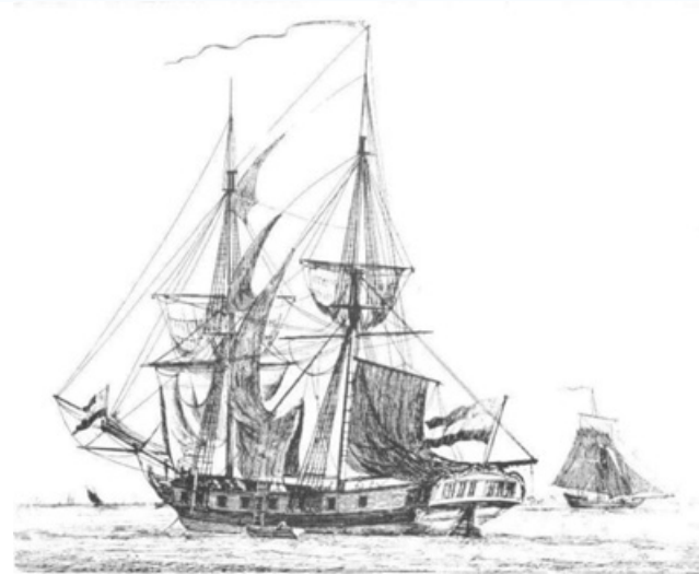
Brik: Kleine tweemaster, volgetuigd (= razeilen aan alle masten). Vergelijkbaar met brigantijn
